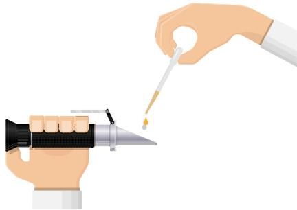
**Schritt 1:** Einen Tropfen Kolostrum auf das Glas des Refraktometers geben und Deckel schließen.
